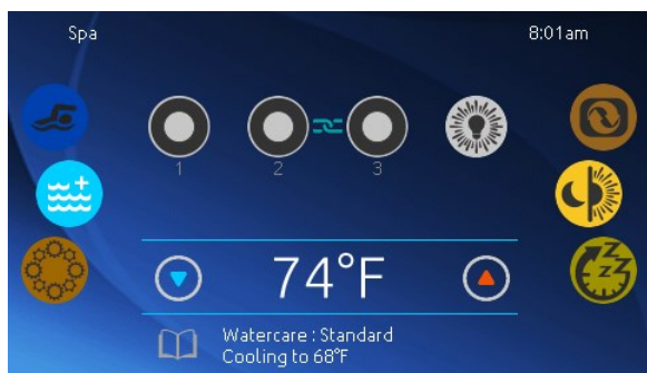
Figure 1 : écran principal avec les pompes éteintes
